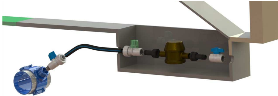
Figura 5. Acometida de piso \frac{1}{2} " con registros en PVC.
