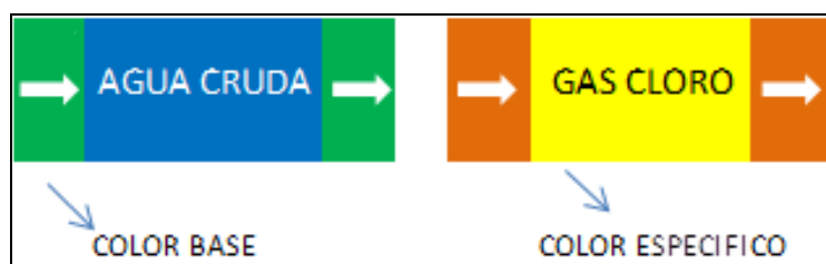
Figura N°3. Ejemplo de marcación de tubería
