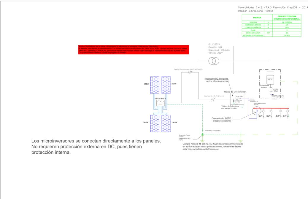
DIAGRAMA UNIFILAR CON CONEXIÓN DE AGPE O GD
