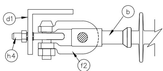
FIJACIÓN AISLADORES DE SUSPENSIÓN A CRUCETAS CONDUCTORES < 266,8 kcmil - ACSR
