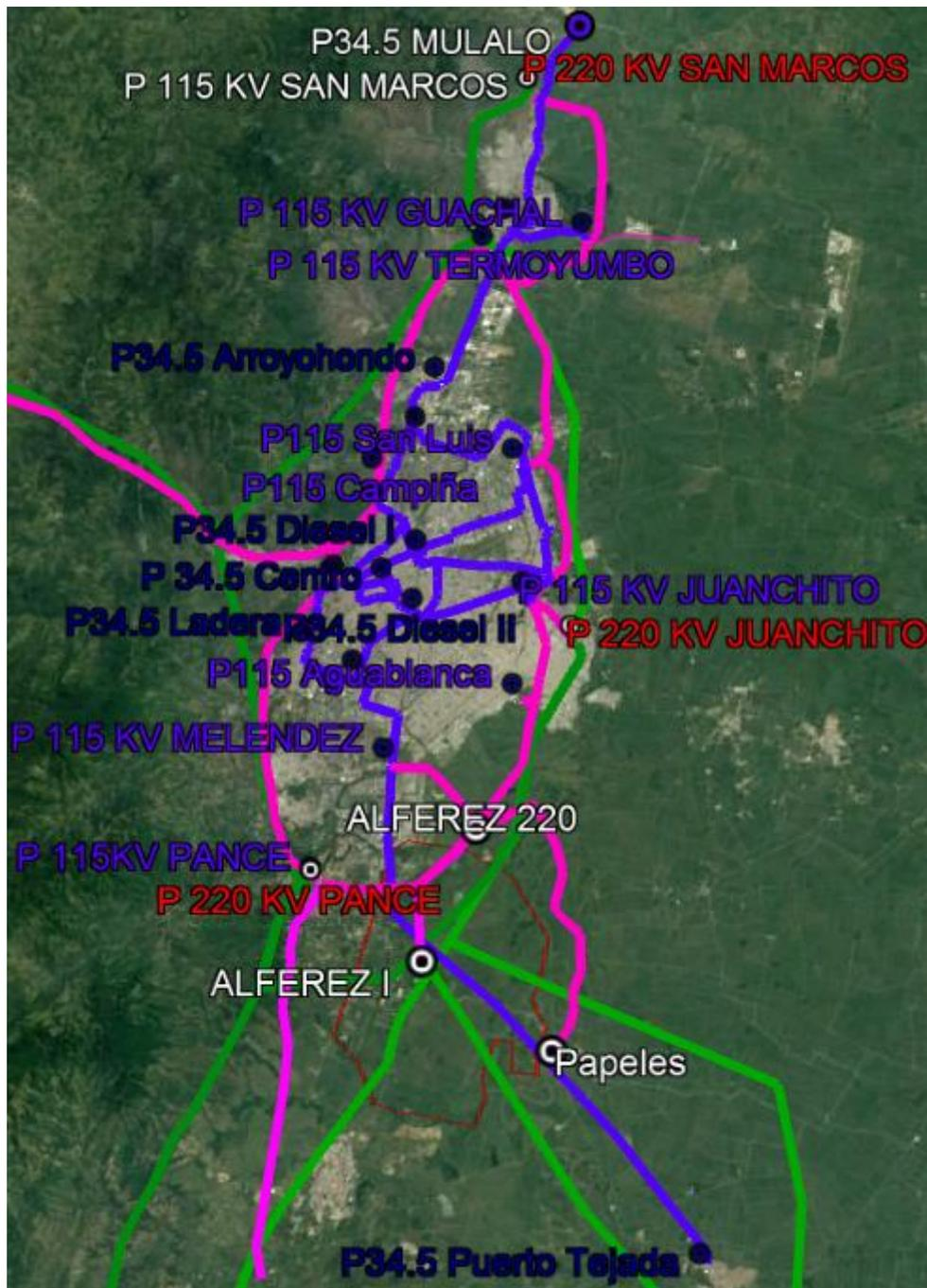
Figura 1. Topología del SDL EMCALI. Verde: 230 kV, magenta 115 kV, azul 34.5 kV.
